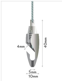
**IT** gancio per pannelli con sistema autobloccante. gancio multiuso per cavo di acciaio o di nylon. nella parte superiore si infila il cavo di acciaio, mentre nella parte inferiore si possono agganciare i pannelli. il fissaggio del cavo è semplice e veloce grazie al sistema autobloccante: inserire il cavo nel gancio, il meccanismo di autobloccaggio trattiene automaticamente il cavo. materiale: ottone cromato. spessore del cavo: max. Ø1,2mm.
