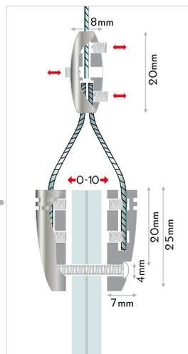
**IT** morsetto variabile in acciaio per pannelli con cavi. morsetto per cavi di acciaio o di nylon o per catenelle. il fissaggio del pannello e del cavo avviene tramite le brugole. fissaggio: morsetto per pannelli, variabile, per diversi spessori, sistema a brugola. materiale: acciaio AISI303. spessore del pannello: max. 10mm. grazie all'utilizzo di brugole più lunghe è possibile fissare anche spessori maggiori. spessore del cavo: max. Ø1,8mm.
