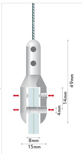
**IT** morsetto variabile in acciaio per pannelli con cavi. morsetto per cavi di acciaio o di nylon o per catenelle. il fissaggio del pannello e del cavo avviene tramite le brugole. materiale: ottone con cromatura. spessore del cavo: max. Ø1,8mm.
