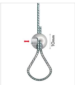
**IT** fermacavo. far passare il cavo di acciaio o di nylon all'interno del fermacavo e bloccarlo con la brugola. materiale: ottone cromato. spessore del cavo: max. Ø1,8mm.
