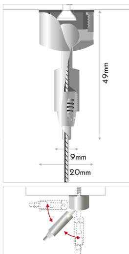
**IT** tirante snodabile per cavi, sistema autobloccante. fissaggio a soffitto universale per cavi di acciaio o nylon. montare il tirante a soffitto e inserire il cavo nel morsetto. il meccanismo di autobloccaggio trattiene automaticamente il cavo. materiale: ottone cromato. spessore cavo: max. Ø1,2mm.
