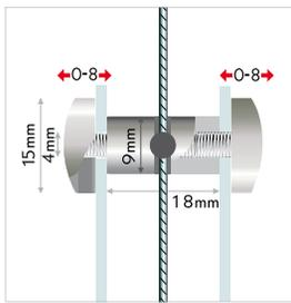
**IT** connettore bifacciale per pannelli con sistema a brugola. per la connessione laterale di due pannelli su cavi di acciaio. il fissaggio avviene tramite una brugola. fissaggio: connettore bifacciale, a due lati, per pannelli su cavi di acciaio, con sistema a brugola. materiale: ottone cromato, spessore del cavo: max. Ø1,2mm.
