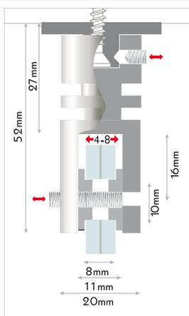
**IT** morsetto a bandiera in acciaio per parete o soffitto. per montaggi di pannelli a bandiera o direttamente a soffitto. il fissaggio del pannello avviene tramite le brugole. anellini di protezione inclusi. fissaggio: morsetto a bandiera con sistema a brugola. materiale: acciaio inox AISI303.
