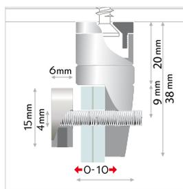
**IT** morsetto variabile a bandiera per parete o soffitto. per montaggi di pannelli a bandiera o direttamente a soffitto. morsetto flessibile per pannelli con diversi spessori. il fissaggio del pannello avviene tramite le brugole. fissaggio: morsetto variabile a bandiera con sistema a brugola. materiale: ottone cromato.
