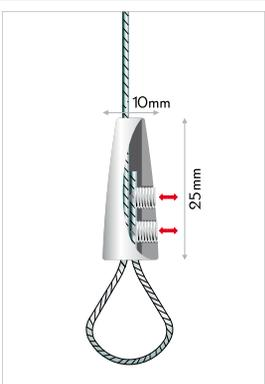
**IT** fermacavo. far passare il cavo di acciaio o di nylon all'interno del fermacavo e bloccarlo con la brugola. materiale: ottone cormato. spessore del cavo: max. Ø1,8mm.
