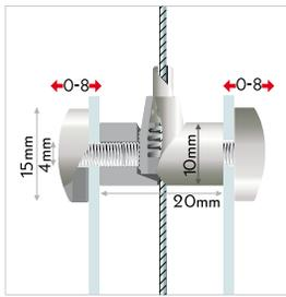
**IT** connettore bifacciale per pannelli, sistema autobloccante. per la connessione laterale di 2 pannelli su cavi di acciaio tramite brugola. il meccanismo di autobloccaggio trattiene automaticamente il cavo. materiale: ottone cromato. spessore del cavo: max. Ø1,2mm.
