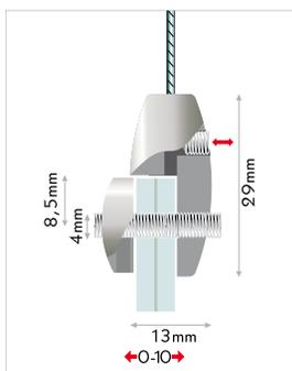
**IT** morsetto variabile per pannelli con cavi. morsetto per cavi di acciaio o di nylon o per catenelle. il fissaggio del pannello e del cavo avviene tramite le brugole. materiale: ottone con cromatura. spessore del cavo: max. Ø1,8mm.
