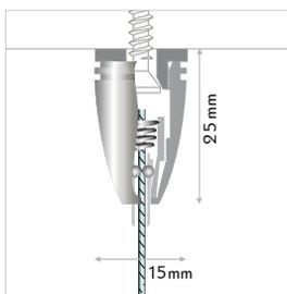
**IT** tirante in acciaio per cavi con sistema autobloccante. fissaggio a soffitto universale per cavi di acciaio o di nylon. montare il tirante a soffitto e inserire il cavo nel morsetto. il meccanismo di autobloccaggio trattiene automaticamente il cavo. materiale: acciaio AISI303. distanza dal soffitto: 25mm. spessore del cavo: max. Ø1,2mm.
