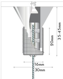
**IT** tirante per cavi, sistema in tensione a brugola. fissaggio a soffitto universale per cavi di acciaio, nylon o per catenelle. montare il tirante a soffitto, inserire il cavo nel morsetto e fissarlo con le brugole. regolare la tensione avvitando la parte zigrinata. materiale: ottone cromato. spessore del cavo: max. Ø1,8mm.
