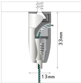
**IT** tirante per cavi con sistema autobloccante. fissaggio a soffitto per cavi di acciaio. montare il tirante a soffitto, inserire il cavo nel morsetto e regolare la tensione e la lunghezza del cavo grazie al forellino laterale. il meccanismo di autobloccaggio trattiene il cavo. materiale: ottone con cromatura. spessore del cavo: max. Ø1,2mm.
