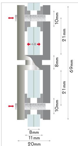
**IT** connettore in acciaio per pannelli. morsetto in acciaio inox per la connessione verticale di pannelli. il fissaggio avviene tramite le brugole. anellini di protezione inclusi. fissaggio: connettore di pannelli. materiale: acciaio inox AISI303
