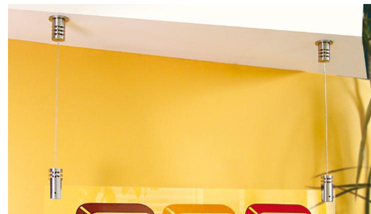
**IT** tirante in acciaio per cavi con sistema a brugola. fissaggio a soffitto universale, in acciaio inox, per cavi di acciaio o di nylon o per catenelle. montare il tirante a soffitto, inserire il cavo nel morsetto e fissarlo con le brugole. fissaggio: tirante per cavi, sistema a brugola. materiale: acciaio AISI303, testina con sfaccettature. distanza dal soffitto: 35mm. spessore del cavo: max. Ø1,8mm.
