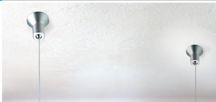
**IT** tirante per cavi, sistema in tensione a brugola. fissaggio a soffitto universale per cavi di acciaio, nylon o per catenelle. montare il tirante a soffitto, inserire il cavo nel morsetto e fissarlo con le brugole. regolare la tensione avvitando la parte zigrinata. spessore del cavo: max. Ø1,8mm.
