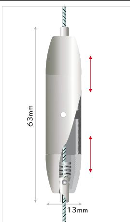
**IT** tensionatore per cavi con sistema autobloccante. per un'ottima tensione di cavi molto lunghi. inserire l'estremità del cavo in link, dove il sistema autobloccante lo tratterrà, e regolare la tensione avitandolo. il forellino centrale garantisce un avitamento più stretto. spessore del cavo: max Ø1,2mm.
