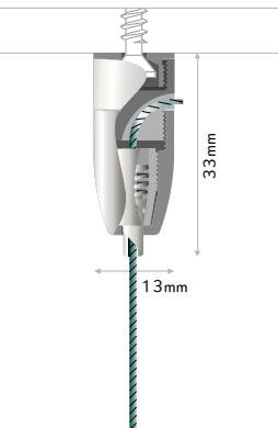
**IT** tirante per cavi con sistema autobloccante, fissaggio a soffitto per cavi di acciaio. montare il tirante a soffitto, inserire il cavo nel morsetto e regolare la tensione e la lunghezza del cavo grazie al forellino laterale. il meccanismo di autobloccaggio trattiene il cavo. spessore del cavo: max. Ø1,2mm.
