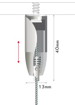
**IT** tirante per cavi, sistema in tensione autobloccante. montare il tirante ed inserire il cavo: il sistema di autobloccaggio lo trattiene automaticamente. regolare la tensione del cavo avvitando il tirante. spessore del cavo: max. Ø1,2mm.
