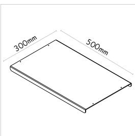
**IT** ripiano in acrilico satinato per il montaggio a sospensione sui cavi di acciaio. arc, pod e cavo di acciaio da ordinare separatamente.
