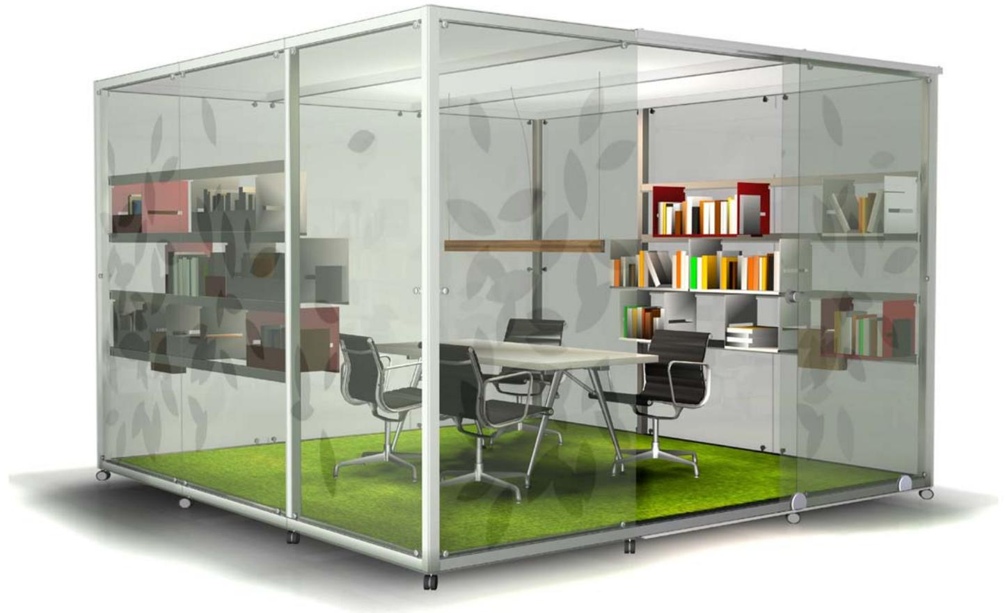
constructiv ottobox **im Achsmaß 3.600 x 3.600 x 2.400 mm**, mit Bodenanlage, auf Höhenverstellern stehend, bodengeführte Glasschiebetür, Wand- und Deckenfüllungen aus 8 mm ESG / VSG - Glas, mittleres Deckenfeld mit Akustikpanel.
