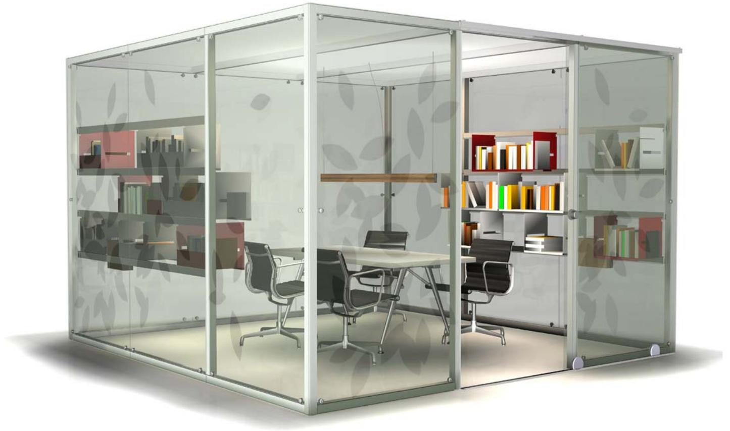
constructiv ottobox **im Achsmaß 3.600 x 3.600 x 2.400 mm**, ohne Bodenanlage, auf vorhandenem Boden stehend, bodengeführte Glasschiebetür, Wand- und Deckenfüllungen aus 8 mm ESG / VSG - Glas, mittleres Deckenfeld mit Akustikpanel.
