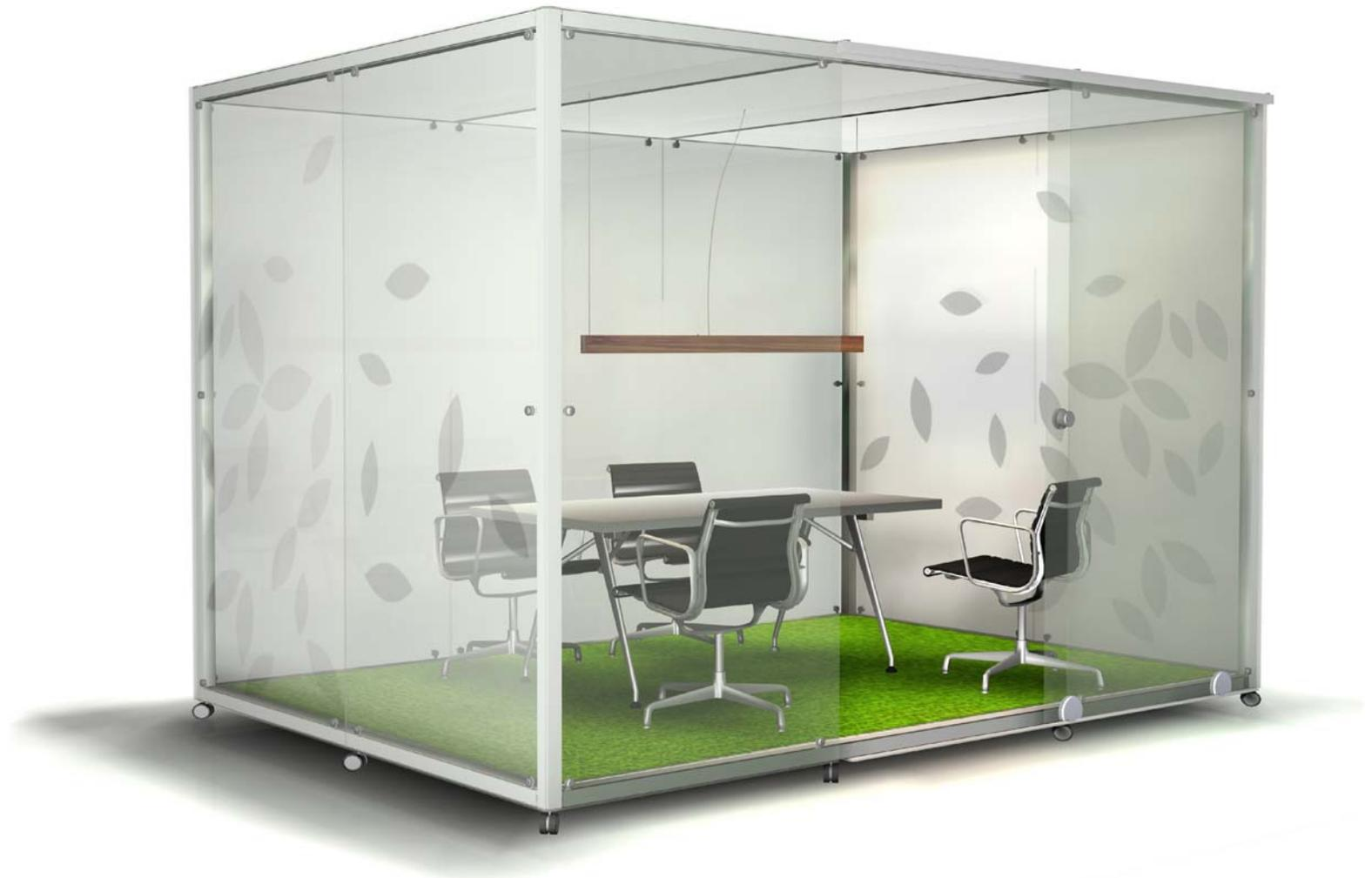
constructiv ottobox im **Achsmaß 3.600 x 2.400 x 2.400 mm**, mit Bodenanlage, auf Rollen stehend, bodengeführte Glasschiebetür, Wand- und Deckenfüllungen aus 8 mm ESG / VSG - Glas.
