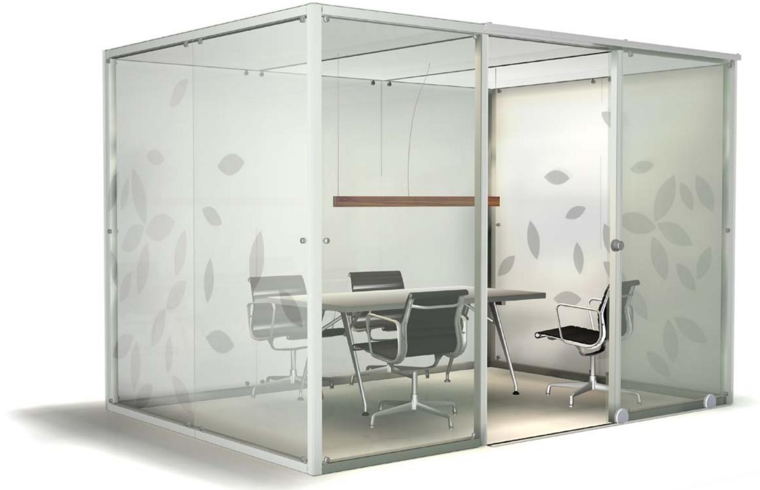
constructiv ottobox im **Achsmaß 3.600 x 2.400 x 2.400 mm**, ohne Bodenanlage, auf vorhandenem Boden stehend, bodengeführte Glasschiebetür, Wand- und Deckenfüllungen aus 8 mm ESG / VSG - Glas, mittleres Deckenfeld mit Akustikpanel.
